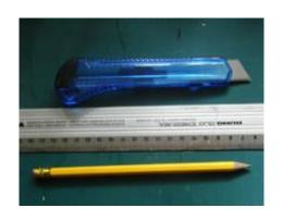
Ein Bleistift zum Vorzeichnen, ein Lineal zum abmessen und ein Cuttermesser zum zu schneiden der Pappe bzw. der Buchseiten
